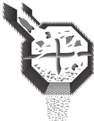
Figura 9 Processo de trituração do Pet
