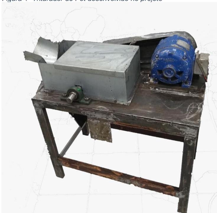
Figura 1- Triturador de Pet desenvolvido no projeto
